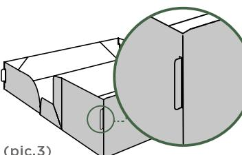
**3** Поднимите наверх боковые стенки дна, как показано на рисунке. Также на поднятой передней стенке опустите замки, загнув их внутрь. При этом выступающие пазы замков должны попасть в прорези на боковых ребрах упаковки. Раздавшийся характерный щелчок свидетельствует о плотном прилегании передней стенки дна.
